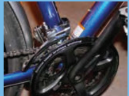
Mekanizmi përcjellës - lloz pedala, dhëmbëzorët lëvizës dhe zinxhiri
