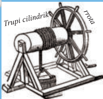
Mekanizmi me çikrik i cili përdoret nëpër puse
